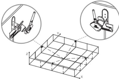
7. 用激光测距仪或卷尺分别测量 4 个基站模块的自定义右手世界坐标系的三维坐标值，水平高度为基站天线中心位置到世界坐标系 x-y 平面的距离，推荐使用铅垂线辅助测量，并将测量结果记录下来。若室内存在互相垂直的墙面，可选用墙角为原点，两个墙面分别为 x 轴和 y 轴，此坐标系即为后续标签模块定位坐标的参考坐标系。
